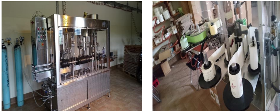
1時間で約600本ボトルング。 イタリアの小規模生産の所には、常設されているとのことでした。
