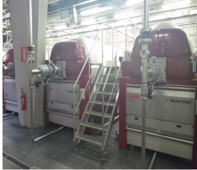
圧搾したブドウを回収し、ゆっくりソフトプレス。ゆっくり行うことで、ぶどうにストレスをかけないようにする。
